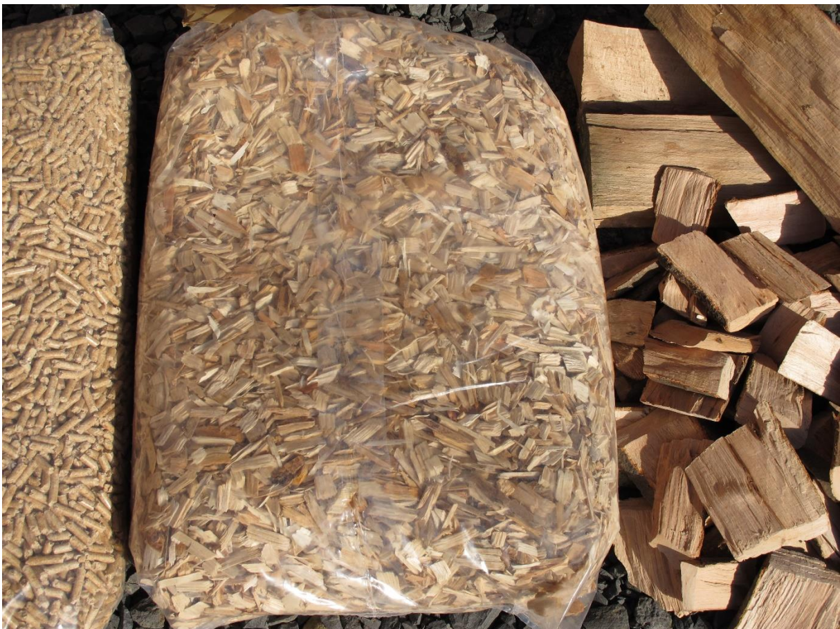
Abb. 2: Gesiebte Sägerestholz-Hackschnitzel P8-16 / M15 / Fichte als Sackware, rechts daneben Grobhackschnitzel P63-100 / M10 / Buche Grill- oder Anmachholz. Quelle: IBT-Krämer
