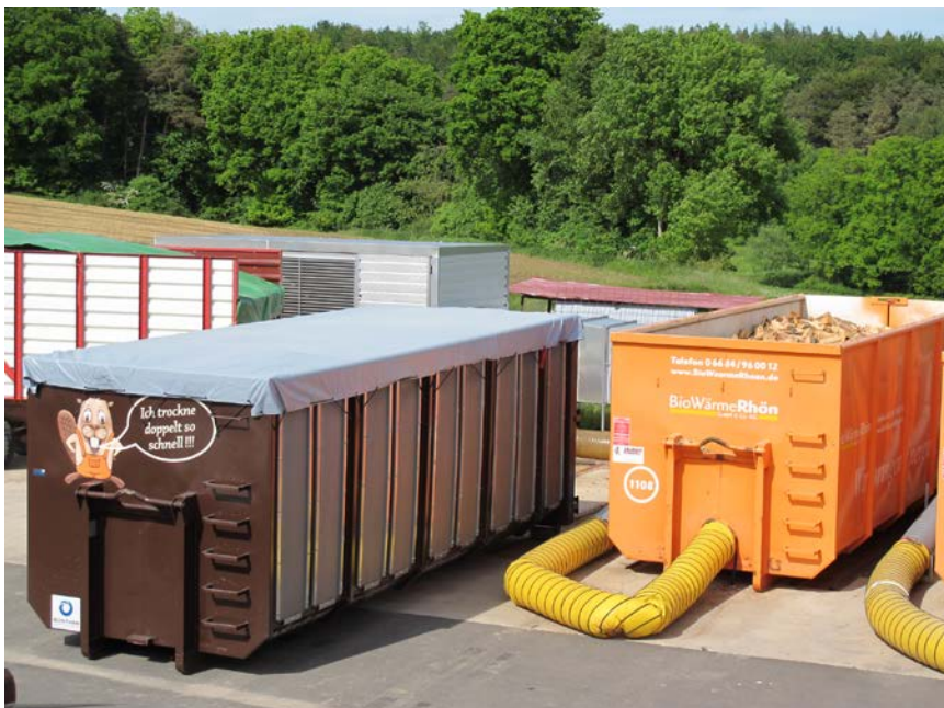
Bild 4: Direktvergleich von Mobiltrockner und herkömmlichem Hakenliftcontainer
