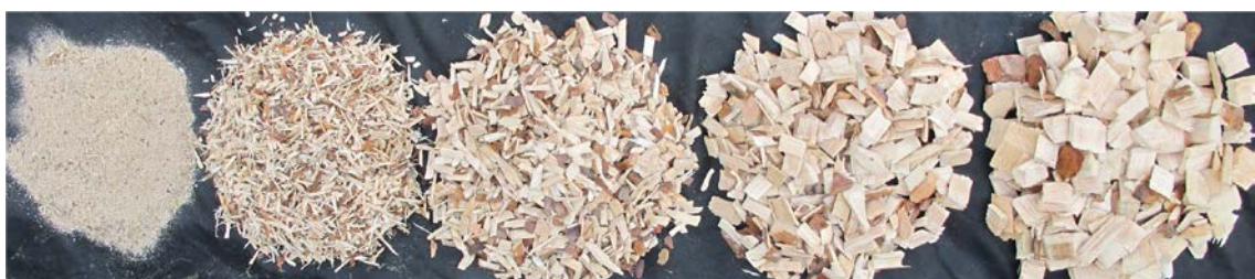
Bild 3: Partikelgrößenverteilung der Kiefern hackschnitzeln mit RETSCH A400 nach EN 14774-1
