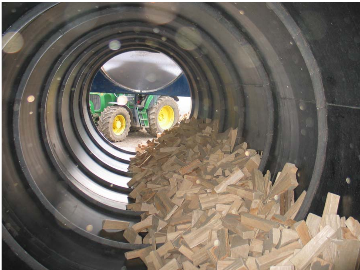
Bild 2: Trommeltrockner S+Ü, Innenrippen zum Transport des Scheitholzes, Foto: KRÄMER
