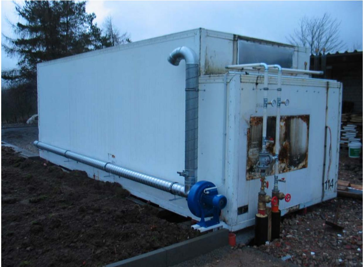
Abb. 3: Kontainertrocknung mit separatem Rippenrohr-Heizregister (Prototyp), Abluft, Umluft und saugseitiger Zuluft. / Foto: KRÄMER, G., 2008
