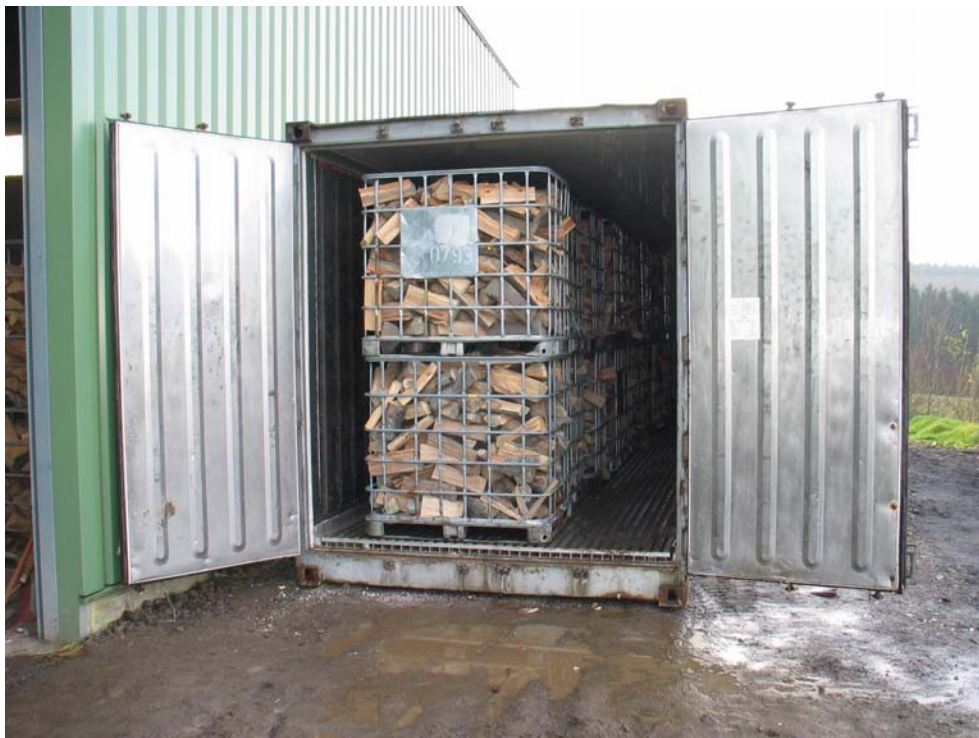
Bild 1: Erste Trockencharge mit ca. 18 srm Buchenscheitholz im Kondenstrockner von Gerd Hoffmann, Gebhardshain / Foto: KRÄMER, 2006
