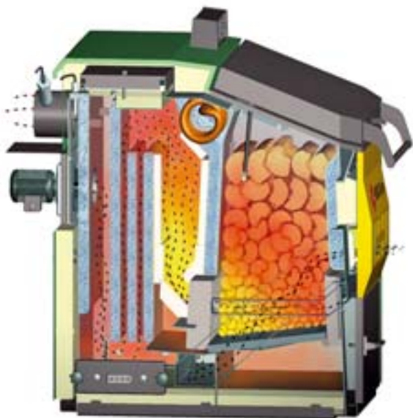
Füllschachtkessel mit großem Rost für unterschiedlich stückiges Restholz (HDG-Bavaria)
